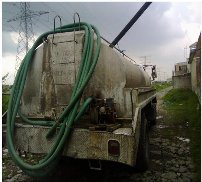
En esta imagen se muestran las condiciones en las que se encuentra la pipa por fuera, pintura muy deteriorada, no está rotulada, la bomba de vaciado no está cubierta o protegida, misma que tiene aceite o grasa, la cual es una fuente de contaminación
