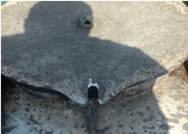
Se muestra la tapa de registro de la pipa cisterna con oxidación y corrosión, así mismo no cuenta con la mariposa de cierre.
