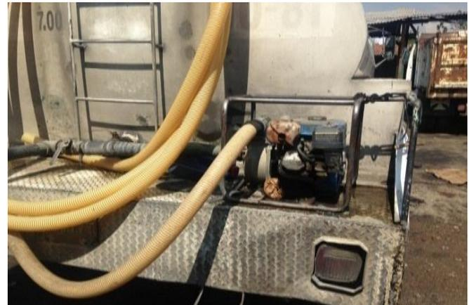
En esta imagen se observa que las conexiones entre la cisterna, válvula y manguera de distribución presentan fugas de agua, así mismo las bombas de achique tienen fugas de aceite por lo tanto ya no están en condiciones de uso.
