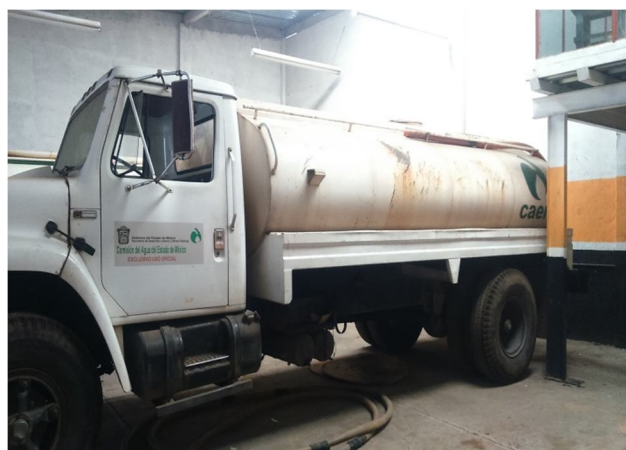
Presenta oxidación la pipa cisterna y sin rotulación del Organismo
