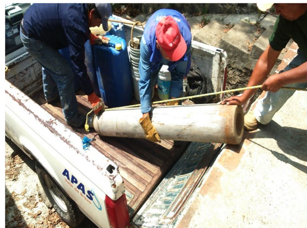
El vehículo no cuenta con abrazadera o cadena que sujete al cilindro.
