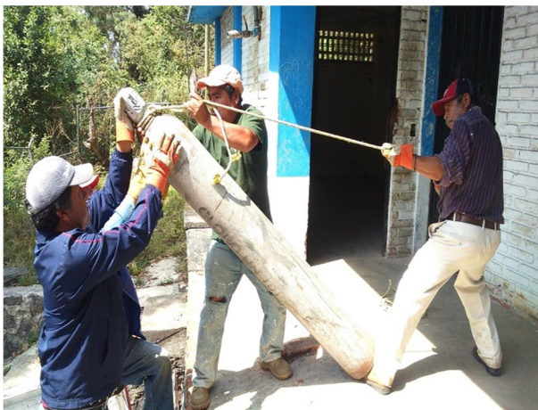
El cilindro es arrastrado peligrosamente.
