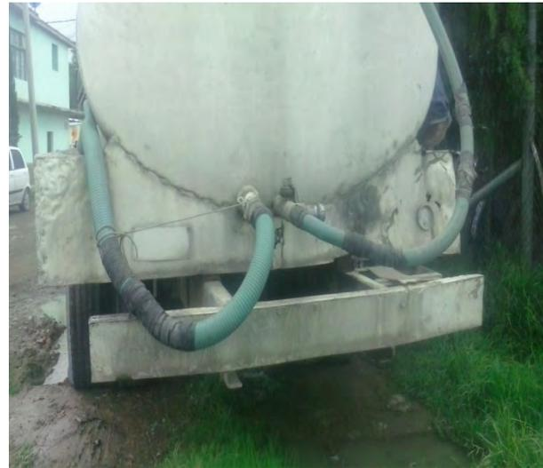
Esta pipa no cuenta con bomba de vaciado del agua, además se observan las condiciones en que se encuentran las mangueras de vaciado.
