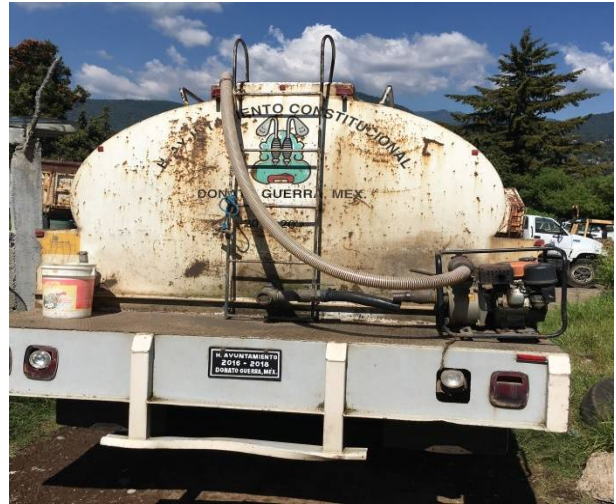
La imagen muestra que las mangueras se encuentran en mal estado.
