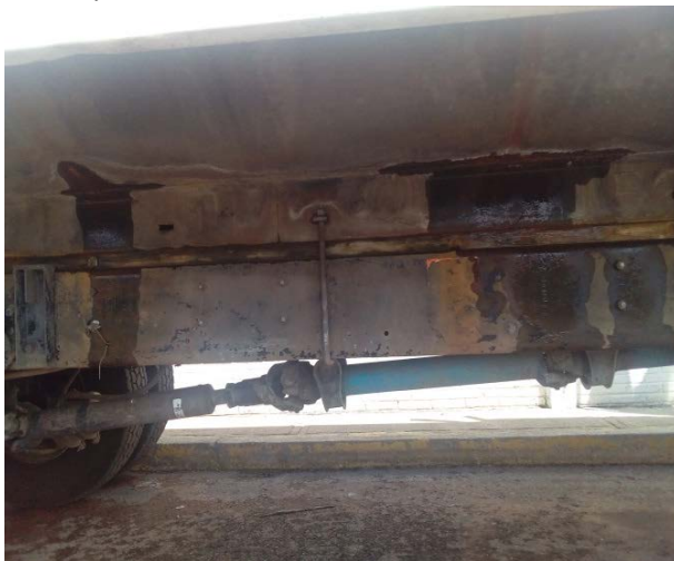
La base de la pipa cisterna 1 muestra fugas.
