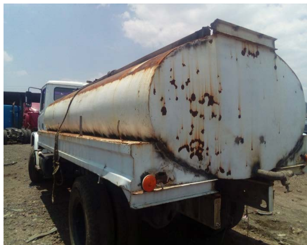
Se observa la necesidad de mantenimiento y pintura de la pipa cisterna 2.
