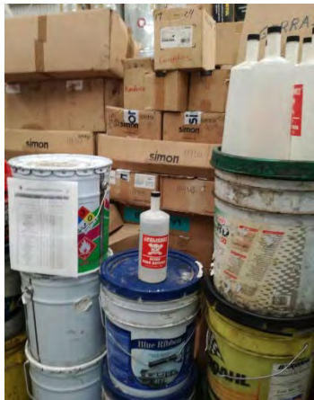
Almacenamiento incorrecto de ácido.
