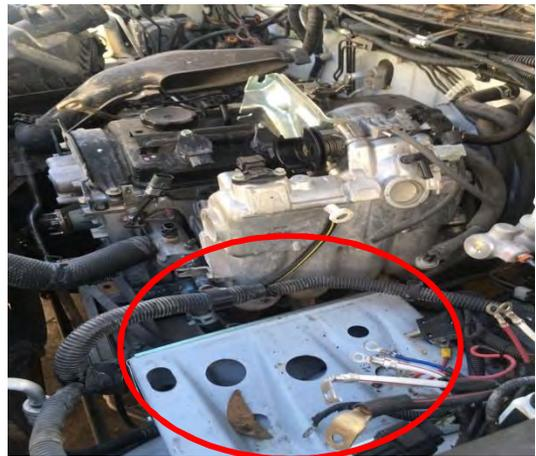
Vehículos con faltantes de piezas resguardados en el DIF de Tezoyuca (Caja de filtro de aire, bobinas de encendido y batería).
