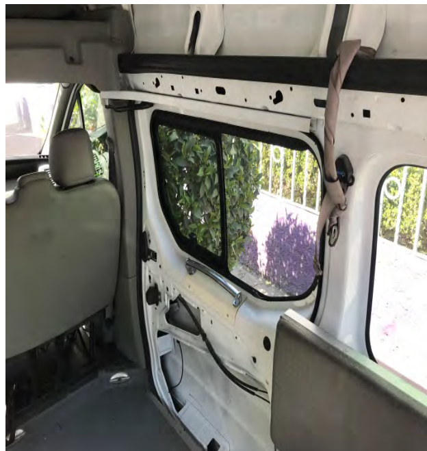
Puerta sin tapa y cinturones de seguridad en mal estado.
