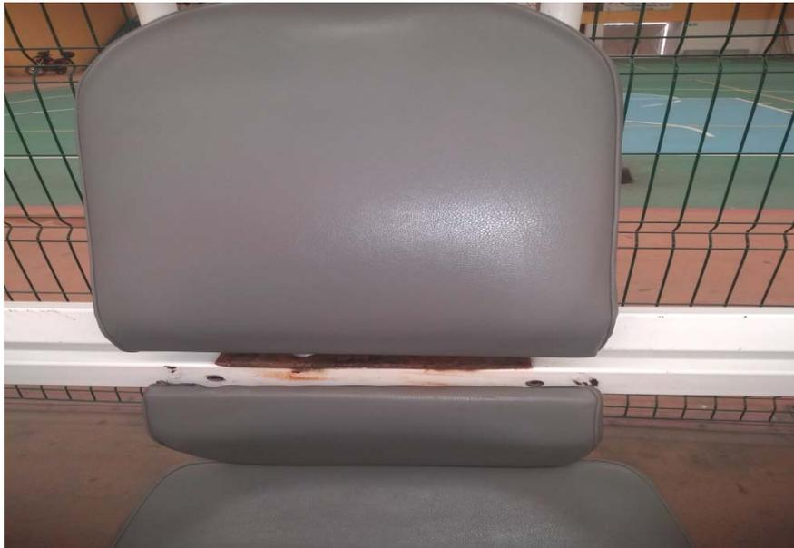
En esta imagen se aprecia que el respaldo del equipo “contractora de abdomen” no está sujeta a su base con tornillos ocasionando un mayor desgaste, por lo que es incómodo para los usuarios hacer deporte.
