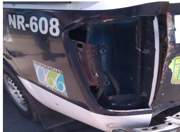
Unidad NR-608 requiere de mantenimiento en faros y calaveras.
