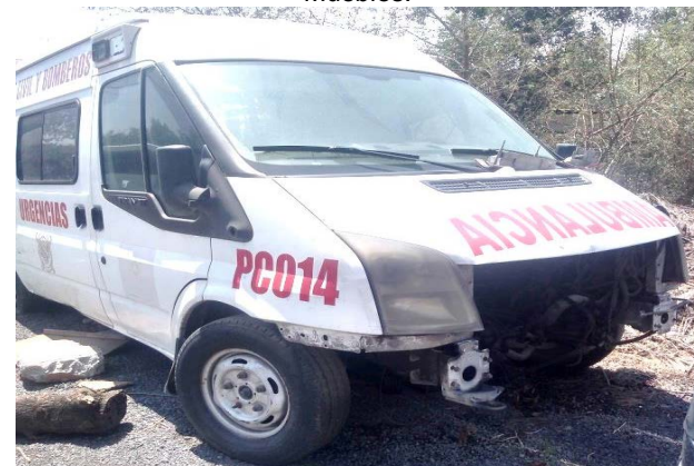
Unidad PC014 le falta el motor.
